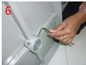
6. Kencangkan Baut yang ada di bagian bawah Base 40 dengan Kunci L
