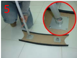
Pasang Tiang S08 ke lubang yang ada di Base Center
